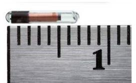
*Passiv-Transponder. Üblicherweise im Innern des Tiers und daher nicht sichtbar, kann jedoch auch am Ring angebracht sein. Dieser Transponder muss mittels speziellem Lesegerät erst aktiviert werden, um ein Signal zu bekommen.*
